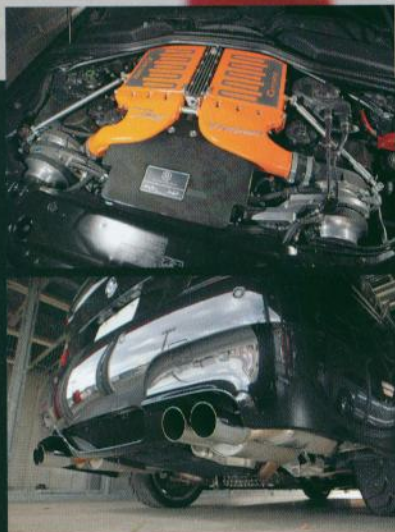
(左上) 黄桃色のエアチャンバーがハイアウトプットを予感させるG-Powerのスーパーチャージャー・システム。左右にターボチャージャー風のベルトドライブ式S/Cユニットが見える。(左) エキゾースト系はマフラーのみSK1キットに組み込まれている。(下) 今回はリヤタイヤのみTOYO PROXES R888に変更されていたが、スラロームテストでは、まだ若干「リヤが出やすい」と判断された。(右上) キドニーグリル内に覗くラジエーターユニットも大容量のものに変更されている。
