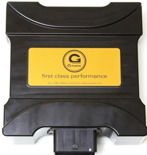
Bild 1: G-POWER Bi-Tronik 5 externes Leistungsmodul
